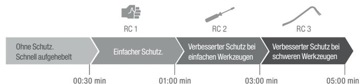
Selbst ohne zusätzliche Stahlarmierung erreicht GENE0 dank dem stabilen **Faserverbundwerkstoff RAU-FIPRO** bereits die Widerstandsklasse RC 2. Und das bei voller Wärmedämmung. Auf Wunsch ist eine zusätzliche Aufrüstung möglich.
